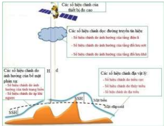
Hình 2.4. Mô phỏng các số hiệu chỉnh trong đo cao vệ tinh (nguồn [51])
