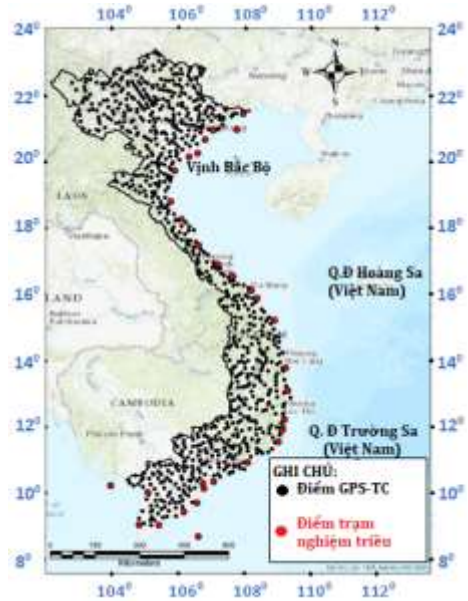
Hình 3.6. Biểu diễn sự phân bố của 818 điểm đo GPS - Thủy chuẩn (màu đen) và 31 trạm nghiệm triều (màu đỏ) trên lãnh thổ Việt Nam.
